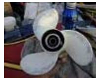
プロペラ欠損補修
