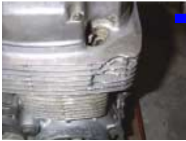
空冷エンジン冷却フィンの破損
