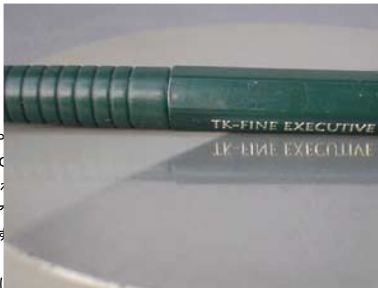
半分磨き加工した GM-8300 の硬化見本にペンを載せた写真
